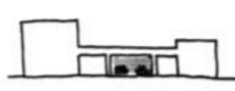
بریدن بنا و ایجاد پل روی مسیر
